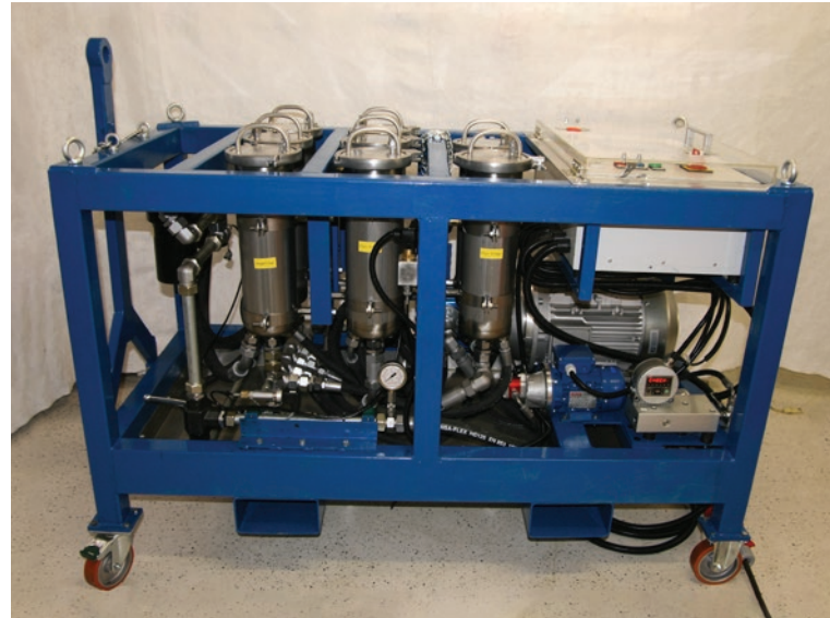
» Slika 1: Hidravlična filtrirna naprava s samodiagnostiko
