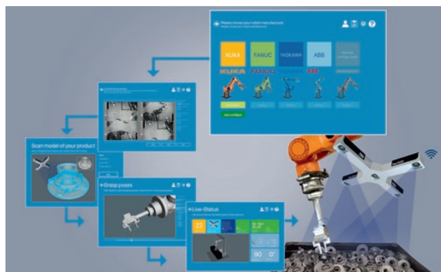
» Standardizirana nastavitvev pobiranja iz zalogovnika v desetih minutah in povezava z vmesnikom robota v enem kliku. | Vir: Isra Vision
