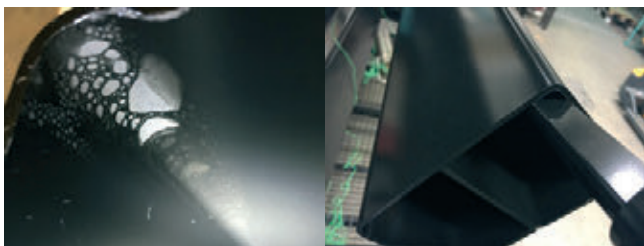
» 3. slika. Posebej oblikovani sorniki (levo) preprečujejo nastajanje zračnih mehurčkov (desno)
