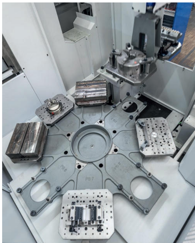
» Pogled od zgoraj na osemmestni revolver 11-mestnega paletnega menjalca PW 150 z osmimi paletami na revolverju, dvema v menjalcu (zgoraj desno) in eno paleto v stroju
