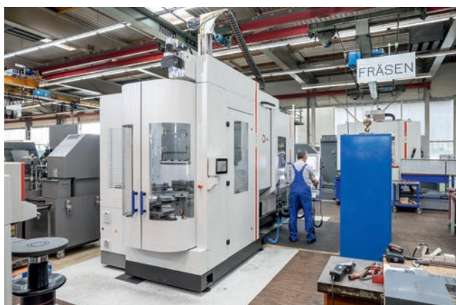
» Paletni menjalec PW 150 na stroju C 22 UP; spredaj je (vrtljiva postaja) za nalaganje palet/vpenjal z obdelovanci in za odstranjevanje dokončanih delov
