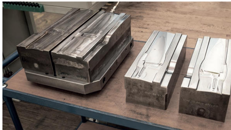
» Levo zgornji in spodnji del kovaškega orodja, vpeta neposredno na paletu brez adapterske plošče, pozicionirana z dvema zatičema in pritrjena s štirimi vijaki; desno obnovljeno orodje
