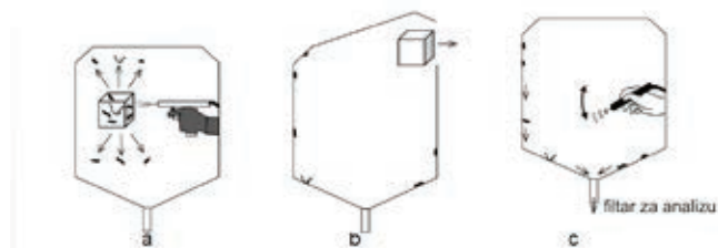
» Slika 5: Suhi postupak uklanjanja i uzimanja čestica s pomoću zraka; a) korak 1: ispuhivanje čestica s proizvoda, b) korak 2: uklanjanje proizvoda iz komore, c) korak 3: čišćenje – ispiranje komore s tekućinom i uzimanje uzorka čestica
