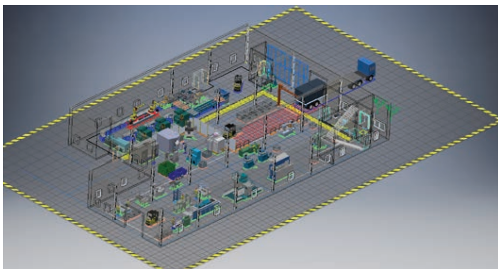
» Slika 4. Prostorno strukturiranje tehnološke opreme u 3D (Inventor)
